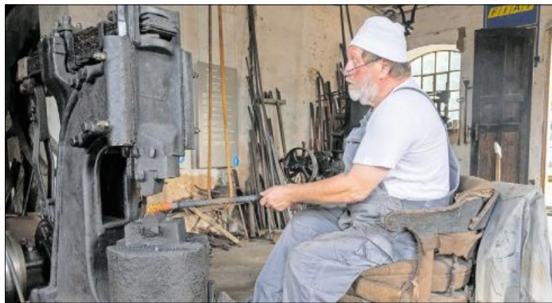
▲ Der Schmied bearbeitet das glühende Eisen am Krafthammer.
